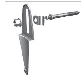
Universalus lietvamzdžio laikiklis, su žaibosaugos gnybtu, iš nerūdijančio plieno, su srieginiu strypu ir dan- tyta veržle
